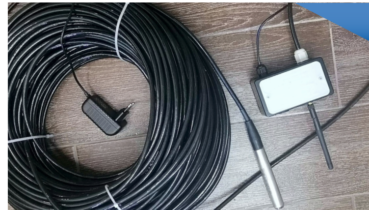
Устройство мониторинга уровня воды
