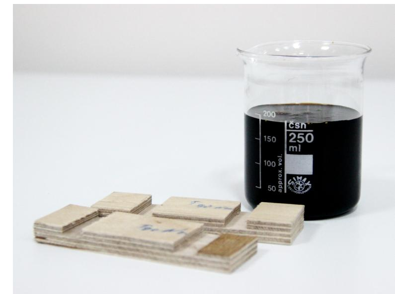
Предел прочности при скалывании по kleевому слою
