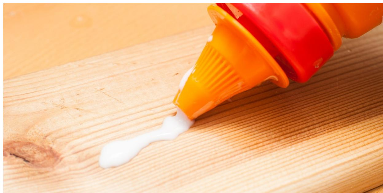
Акриловый клеевой состав – это водно-дисперсионный продукт, в котором молекулярная масса и содержание твердых наполнителей позволяют наносить его механизированным способом. Клей имеет высокое сопротивление старению, объемная усадка при высыхании в естественных условиях не превышает 20%, пластиичность состава предотвращает возникновение напряжения при его усадке.
